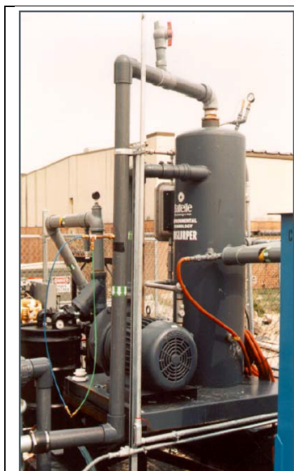
Obrázok 2.1.: Schéma systému dvojfázovej extrakcie TPE [1]
