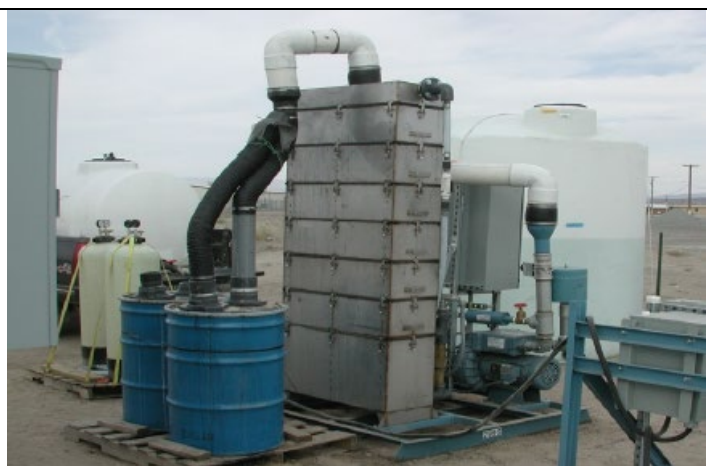
b) Stripovacia veža na odstraňovanie prchavých uhľovodíkov
