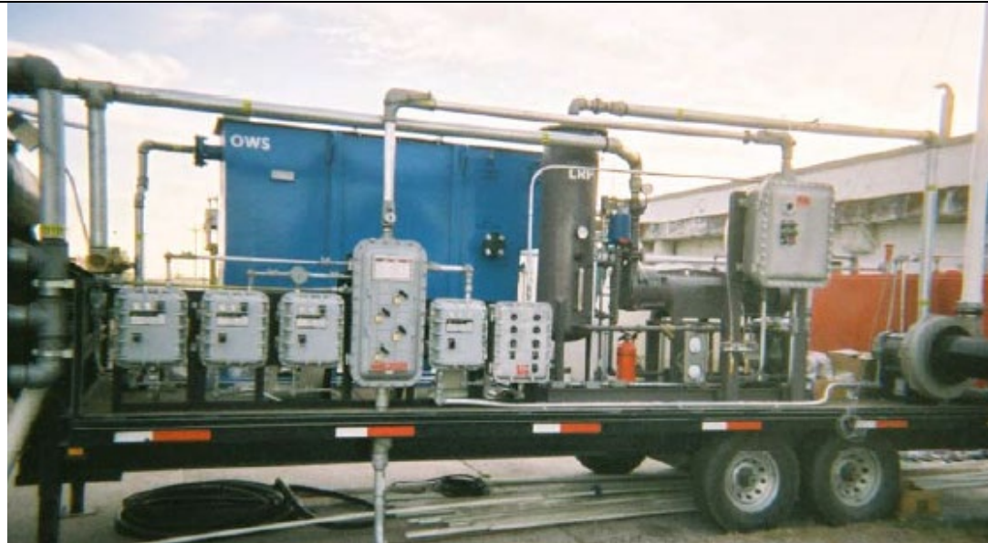
a) Technologické zariadenie na pilotnú skúšku bioslurpingu
